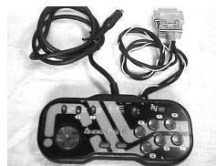
〈写真6〉PCエンジン用アタッチメント。連射回路はこの中のものを使う。
