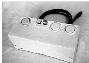
〈写真6〉PCエンジン版専用。中央2つはセレクトボタンとスタートボタン。外箱の材質はボール紙。とても軽い。
