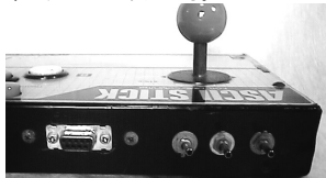
〈写真2〉トグルスイッチ2つは連射切り替え用。1つはBボタンとセレクトを入れ替えるための物。D-Sub9ピンコネクタは拡張用で、各種アタッチメントを接続する。
