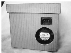
〈写真10〉背面には電源コネクタと排気孔がある。
