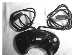
〈写真5〉メガドライブ用アタッチメント。もう一本のケーブルは汎用コントローラを接続する。
