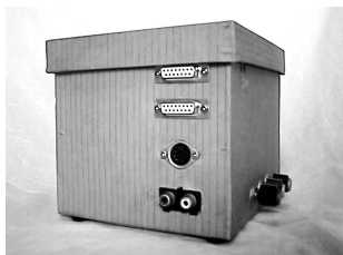
〈写真8〉コネクタは上から1P、2P、画面出力、音声出力になっている。MacやCobaltCubeを先取りした精悍なデザイン。(これもボール紙)しかし、NeXTには負ける。
